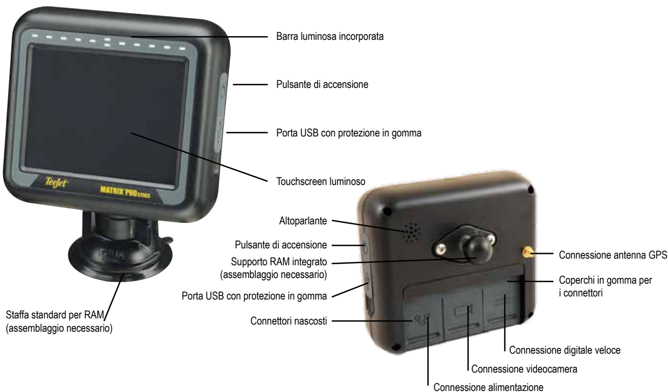
Figure 1-1: Parte anteriore e posteriore della console Matrix Pro 570GS
