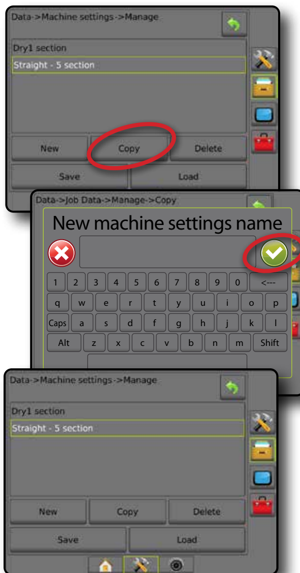
Рисунок 4-40: Настройки машины — копирование профиля
