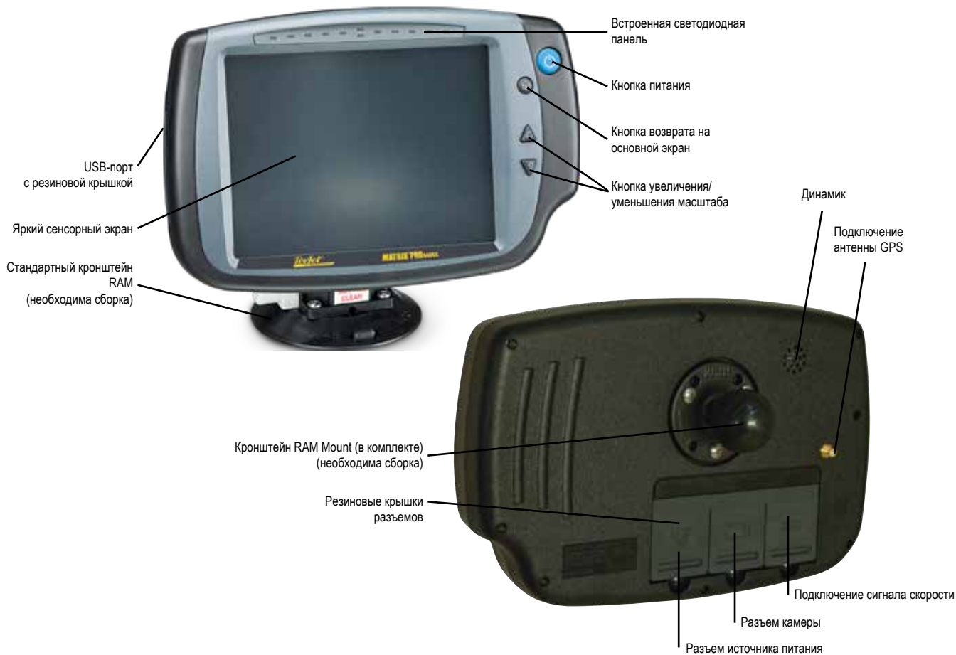
Рисунок 1-2: Консоль Matrix Pro 840GS. Вид спереди и сзади
