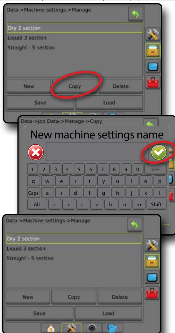
Рисунок 34 — Настройки машины — копирование профиля
