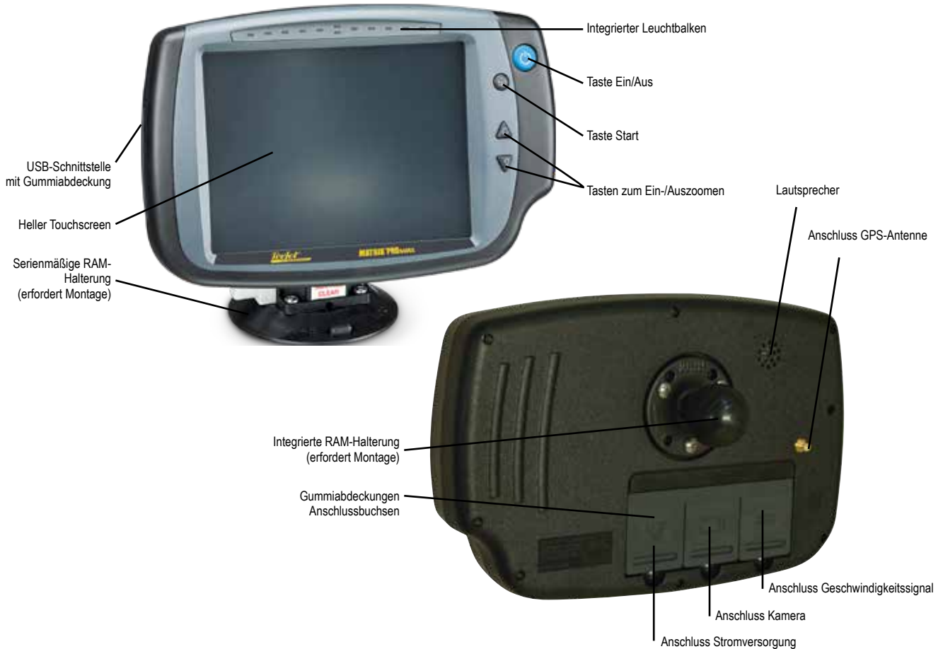
Abbildung 1-2: Matrix Pro 840GS Bedieneinheit, Vorder- und Rückseite
