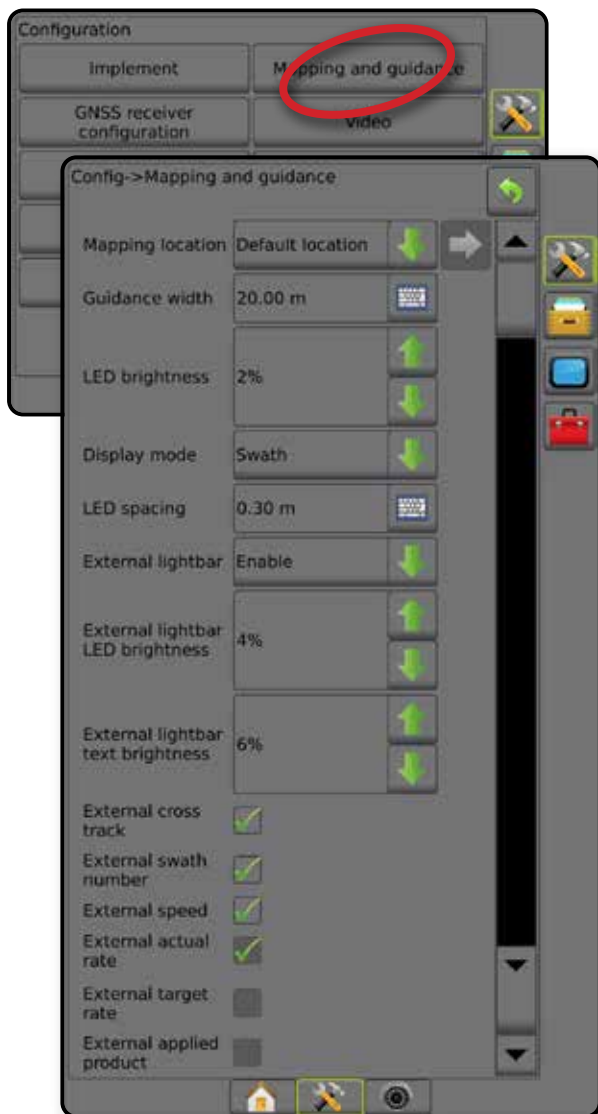
Obr. 4-13: Mapování a navádění s pomocí externího světelného panelu
