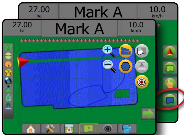
Figura 18: Mappe di copertura, poligoni e dosi obiettivo
