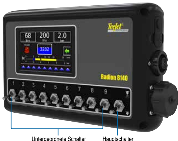
Abbildung 2: Hauptschalter, 9 untergeordnete Schalter
