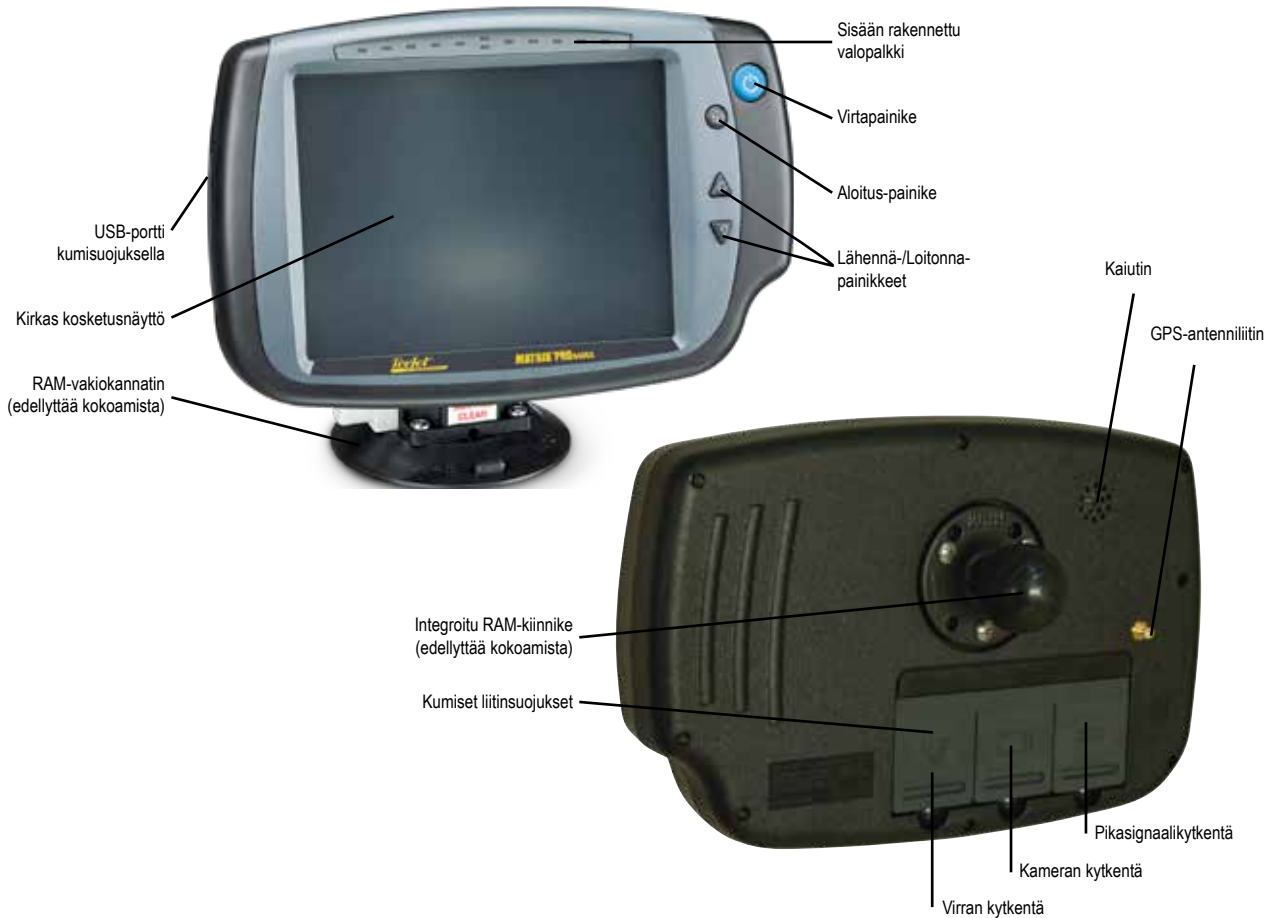
Figure 1-2: Matrix Pro 840GS -konsoli, etu- ja takapuoli
