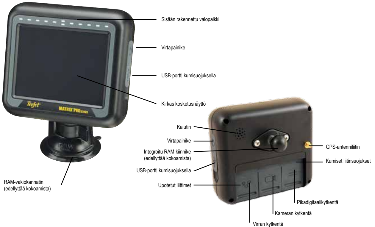
Figure 1-1: Matrix Pro 570GS -konsoli, etu- ja takapuoli
