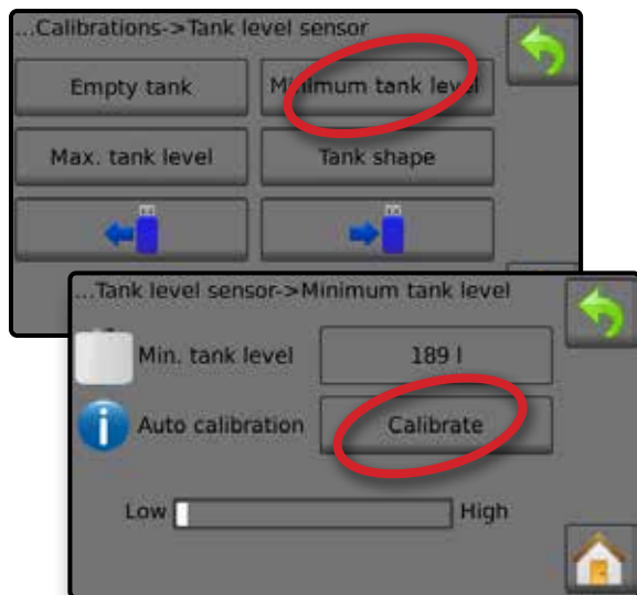
Obr. 35: Senzor hladiny v nádrži – minimální hladina v nádrži
