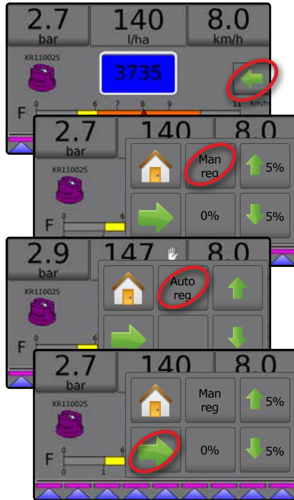
Rysunek 7: Opcje regulacji: automatyczna/ręczna
