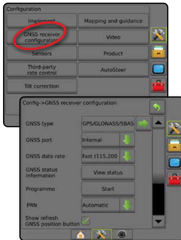
Figure 4-15 : Options de configuration du récepteur GNSS
