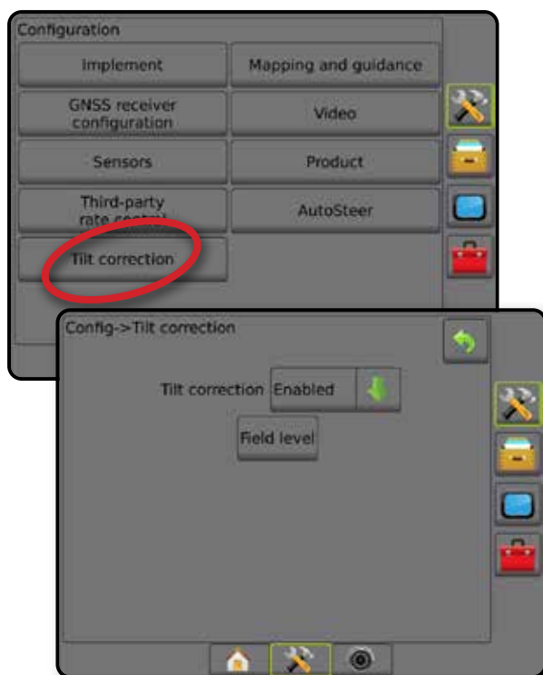
Figure 4-27 : Correction de dévers
