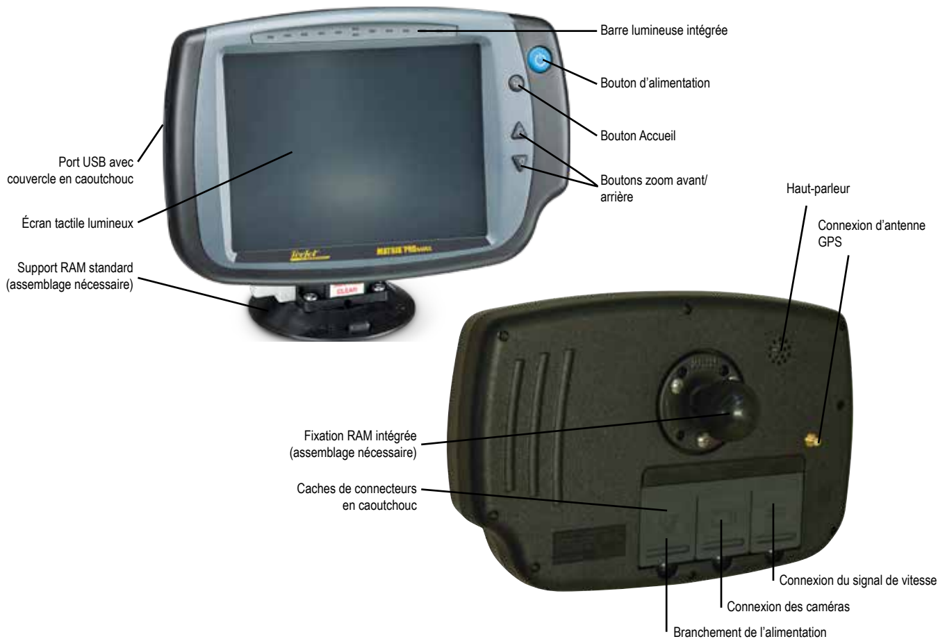
Figure 1-2 : Avant et arrière de la console Matrix Pro 840GS
